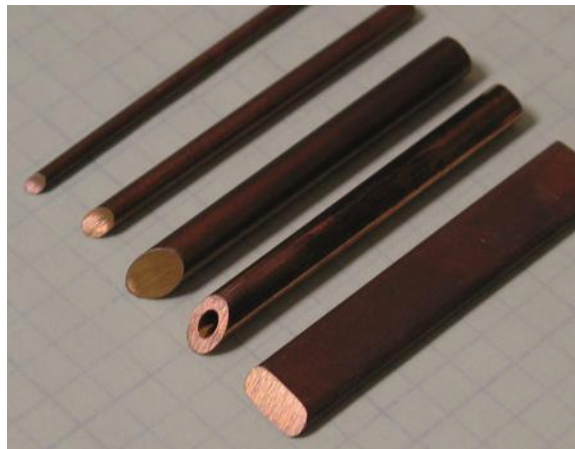
含镍记形合金：单晶记形合金（SCSMA），它采用铜、铝和镍制成。
